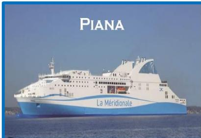
**06/09/22** : La désulfuration des gaz d'échappement et la suppression des particules fines (et ultra fines), associées à la connexion électrique à quai, font sans doute du « Piana », un des navires les plus vertueux de la Méditerranée, assure la compagnie marseillaise « La Mèridionale ». Le système qu'elle a développé avec le belge Solvay et l'autrichien Andritz, constitue une première mondiale sur un navire marchand.
